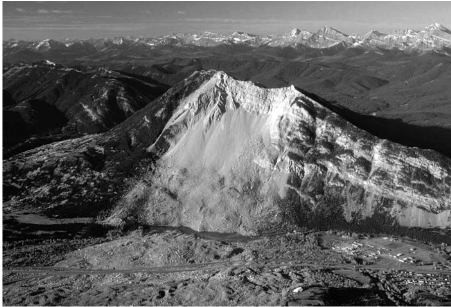
Figure 3: Glissement de terrain de Franck (Rocheuses, Canada) datant du 29 Avril 1903. 74 millions de tonnes (30 millions de mètres cubes, soit 650 mètres de haut par 900 m de large par 150 m d'épaisseur) de calcaire se sont détachés de la montagne, recouvrant trois kilomètres carrés de vallée.
